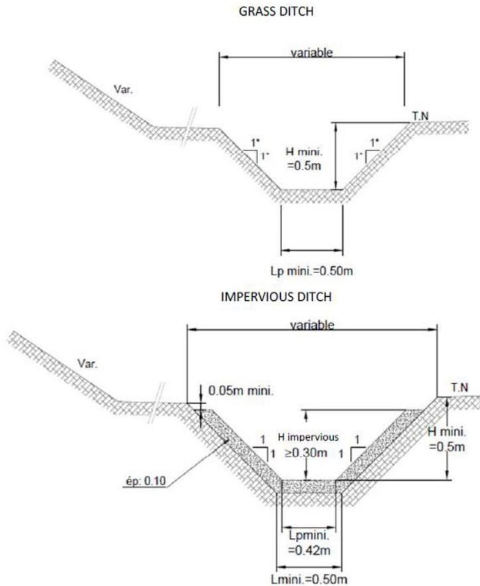
図 3：側溝の典型的な断面図
