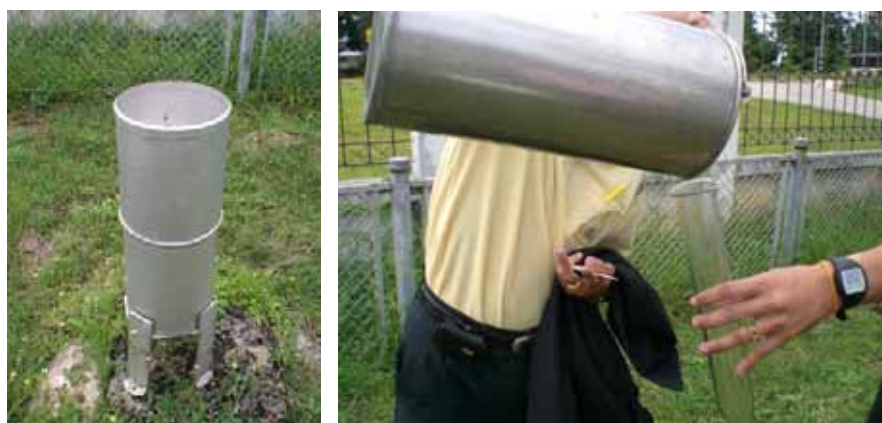
図 13 雨量計およびその測定方法
