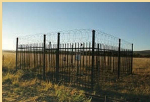
南アフリカ・リンボポ州に 設置された自動気象観測装置
