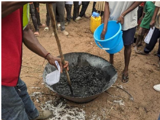
Opérations de trituration pour la production de briquettes
