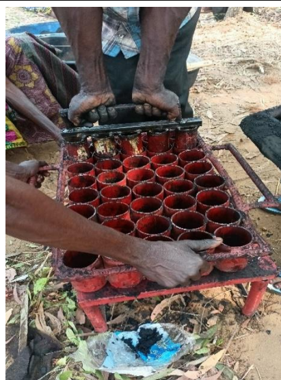
Dispositif de moulage de briquettes fabriqué à titre expérimental au niveau local avec l'appui du projet.
