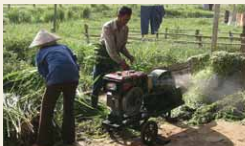
L'utilisation de broyeuses d'herbe permet aux vaches de consommer les herbes dures. Ces machines se sont répandues rapidement lorsque les artisans locaux les ont fabriquées et que leur coût de fabrication a baissé.
