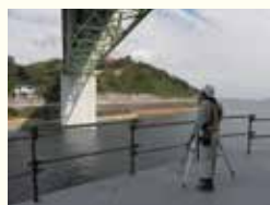
Le système KUMONOS est utilisé pour mesurer à distance les fêlures et les fissures sur les ponts. (Kansai Construction Survey Co., Ltd.)
