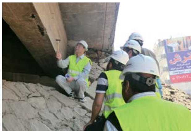
Des ingénieurs égyptiens reçoivent des conseils sur les méthodes d'inspection des ponts (projet d'amélioration des capacités de gestion des ponts).
