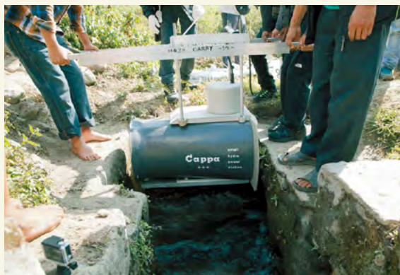
Le petit générateur hydroélectrique Cappa peut être porté par deux adultes.
