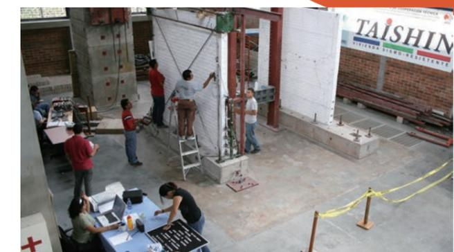
Une maison modèle en construction présente les nouvelles techniques de construction parasismique (en haut à gauche). Un mur est testé pour déterminer sa capacité à résister à un séisme.
