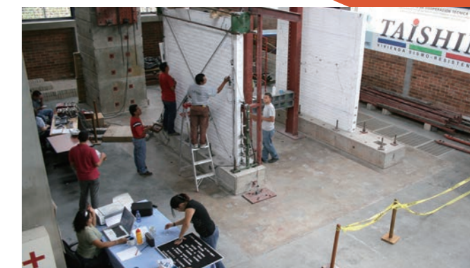
Une maison modèle en construction présente les nouvelles techniques de construction parasismique (en haut à gauche). Un mur est testé pour déterminer sa capacité à résister à un séisme.
