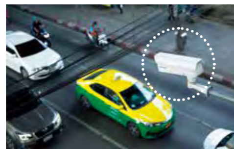
Une caméra surveille le nombre de véhicules qui passent. Des tests ont été menés pour optimiser les feux de signalisation, ce qui a permis de réduire les embouteillages.
