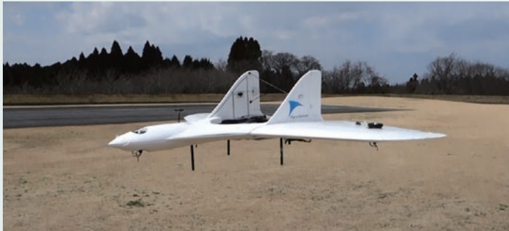
エアロセンスが開発中の固定翼型ドローン。マルチコプターと同様、滑走路を必要としない垂直離着陸機 (VTOL機) だ
