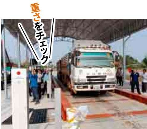
道路の長寿命化には過積載への対策も欠かせない。JICAが整備した計量所での計量の模様。
