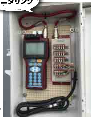
タワーが傾いたトンテイ橋。タワーの上部にモニタリングのための傾斜計を付けて、1年以上にわたって傾斜を計測する。
