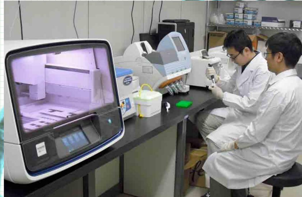
供与機材として導入された次世代DNA解読装置。それまでの機材の約1,000倍の速さで結核菌の遺伝子解析ができるようになった。
