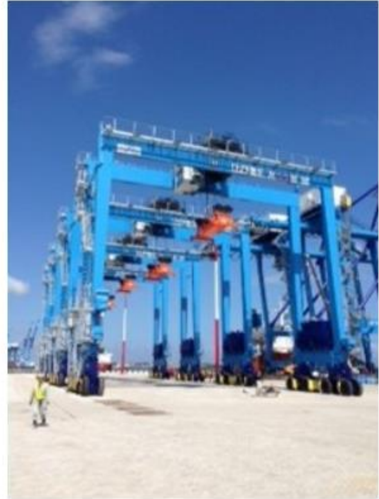
写真右：モンバサ港ヤード用トランスファークレーン(写真：豊田通商)
