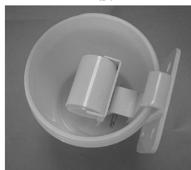
写真A5-1 パッシブ・サンプラー (SO 2 、NO、NO 2 分析用) 写真A5-2 パッシブ・サンプラーの設置
