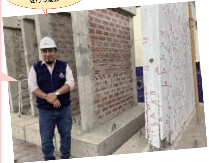
壁の耐震実験を行う施設
