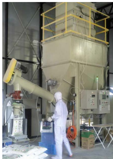
写真右: 割卵工場に設置予定の卵殻乾燥粉碎
