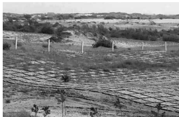
図3 粘土板マルチングによる大規模緑化試験
