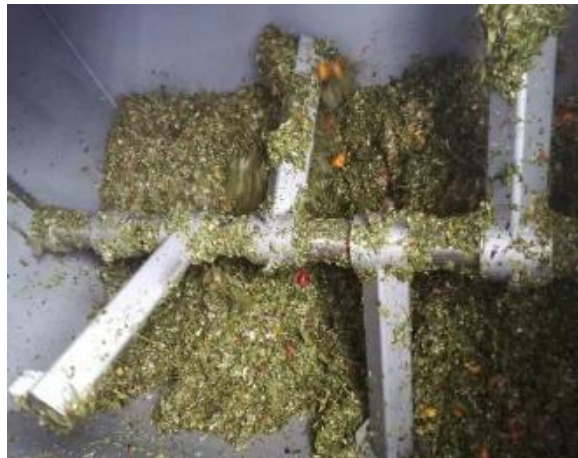
コンポストマシンへ残渣投入、コンポストマシン内部、残渣破碎後
