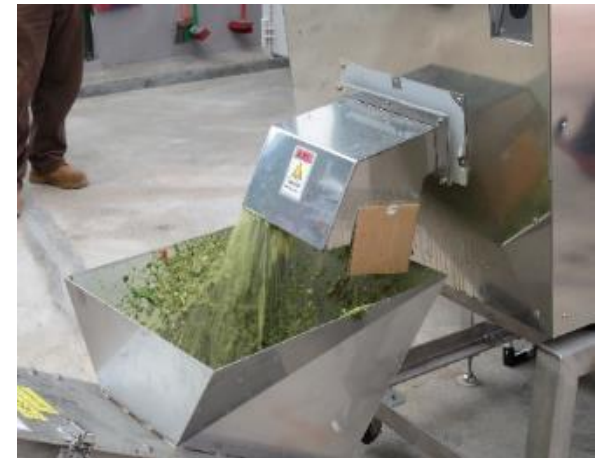
コンポストマシンへ残渣投入、コンポストマシン内部、残渣破碎後
