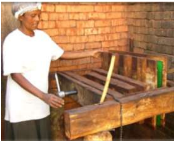
Types de pressoirs, pour l'obtention d'huile brute
