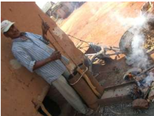
Soufflet utilisé par le forgeron
