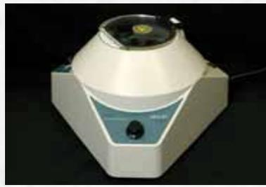
4. Centrifuger à 3000-5000 rpm pendant 15 minutes.
