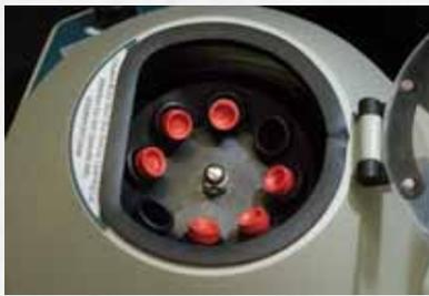
3. En présence de centrifugeuse, mettre les tubes dans la centrifugeuse de façon symétrique en fonction de leur volume pour bien équilibrer la rotation.
