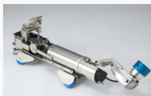
下水道維持管理ロボット 提供：株北菱
