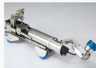
下水道維持管理ロボット 【提供】北菱
