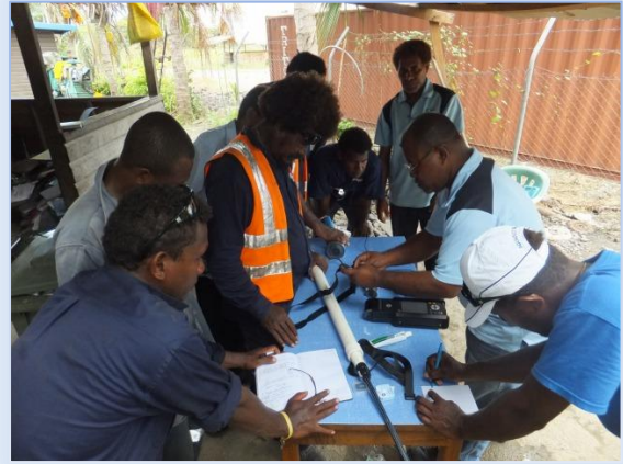
写真-3 本プロジェクトで訓練を受けた スタッフによる他スタッフへの指導 (超音波流量計の条件設定およびセンサ ー装着方法)
