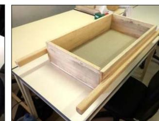
Photos 5 (de gauche à droite) : ① Prototype fabriqué, 45 (P) x 45 (L) x 15 (H) cm ; ② Prototype utilisable par deux personnes.
