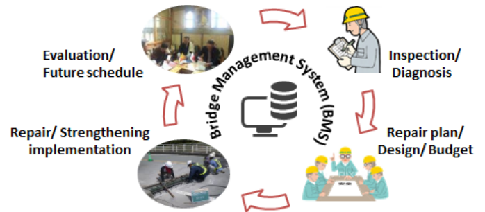
図 2 橋梁維持管理と BMS データベースの仕組み
