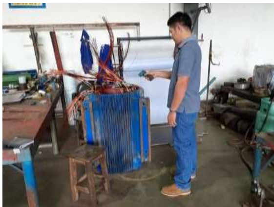
ວັດອຸນຫະພູມໃສ່ Motor stator
