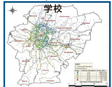
カトマンズ盆地における地震災害リスクアセスメントプロジェクトの結果例(公共施設の被害リスク分布)
