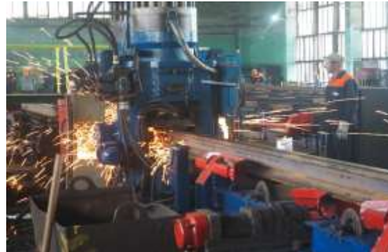
レールの溶接（2024年7月）
