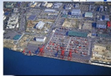
●六甲アイランド地区：岸壁-7.5m外復旧工事 本岸壁は南側隣接のコンテナバース（RC-1）と同様に既存ケーソン前面に新設のケーソンを前出しするデタッチド工法が採用された。復旧工事は5月末に完了し、供用されている。
