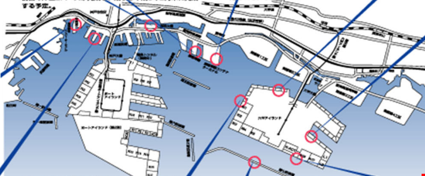
●摩耶地区：岸壁-12m②外復旧工事 摩耶埠頭南側の岸壁にはケーソンタイプの重力式構造と鋼管杭による橋脚構造が採用された。本工程区域は鋼管杭による橋脚構造が採用されている。復旧工事は3月末に完了し、供用されている。
