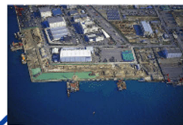
●六甲アイランド地区：-10m岸壁②外復旧工事 本岸壁は被災が比較的軽微であったため、既存ケーソンをそのまま利用するかわりに、ケーソン背後の土圧を低減（事前混合処理工法）する工法が採用された。岸壁の復旧は既に4バースが完成しており、残りの岸壁も9年3月末に完成する予定。
