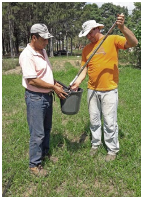
Figura 14. Cargado de la sub muestra de suelo en balde para su homogeneización.
