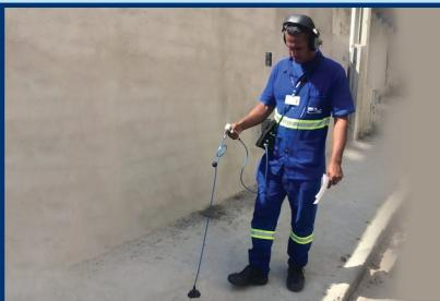
DEMONSTRAÇÃO DE INSPEÇÃO DE VAZAMENTOS
