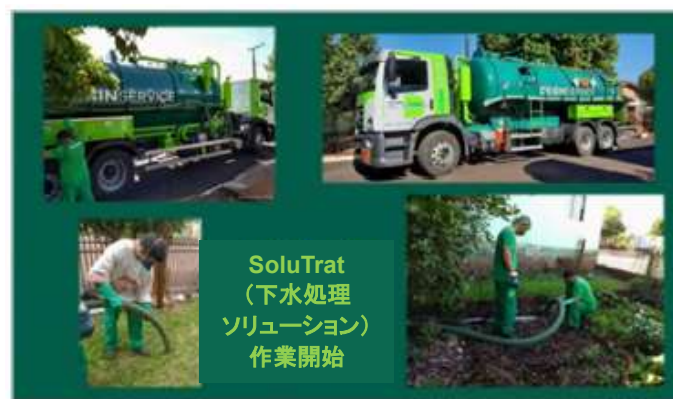
図 18：Corsan による汚泥の収集と輸送
