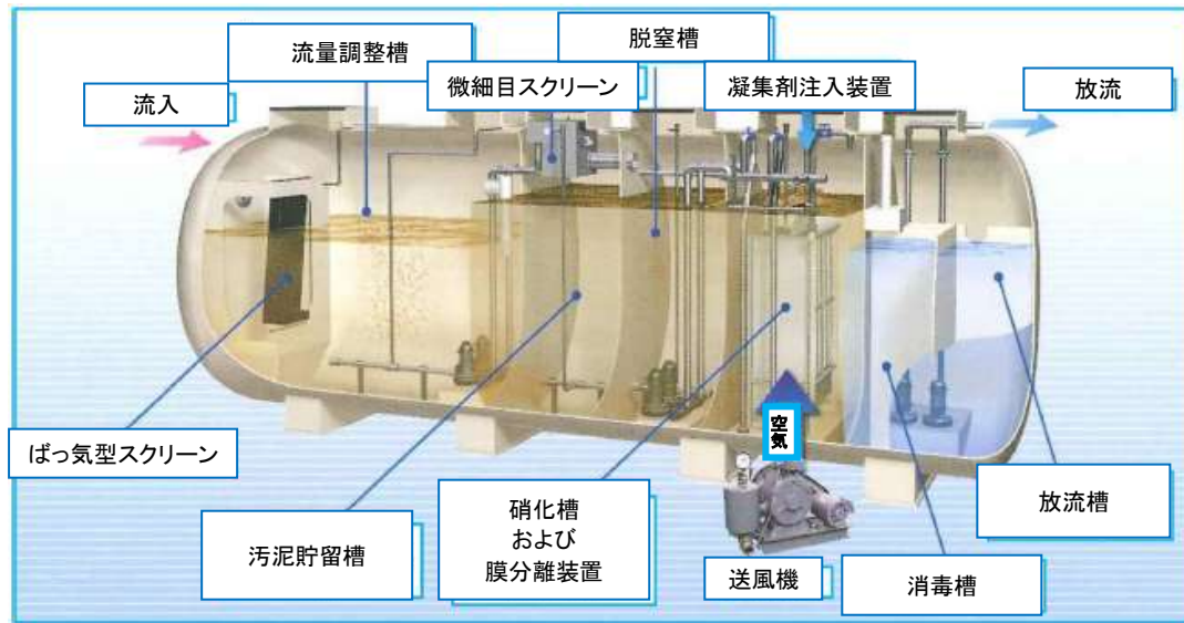
図 30：膜バイオリアクターシステムの断面パース図（クボタ）
