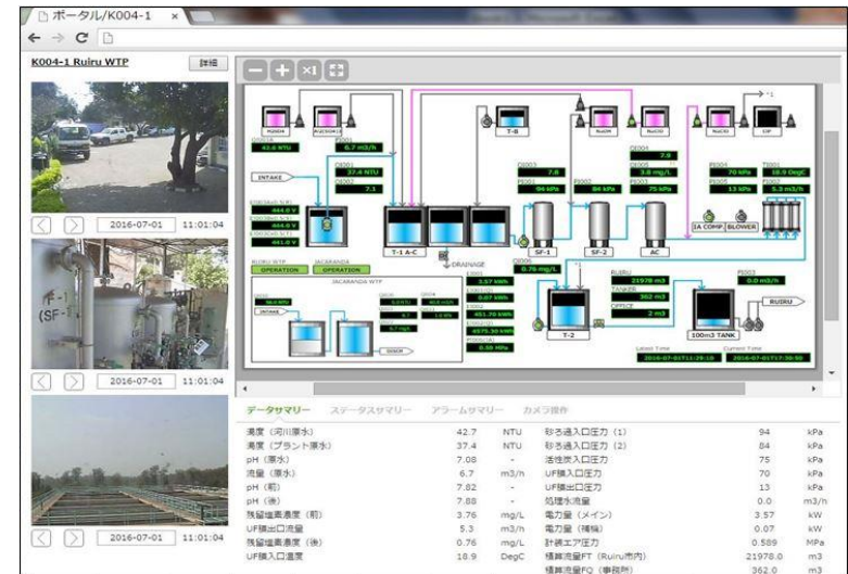
▲日本からも遠隔監視装置(WeLLDAS)を通じて稼働状況を確認
