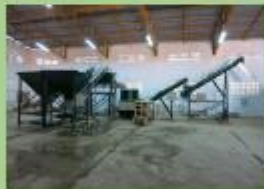
常温合材の製造プラント（RIDラボ内に設置）
