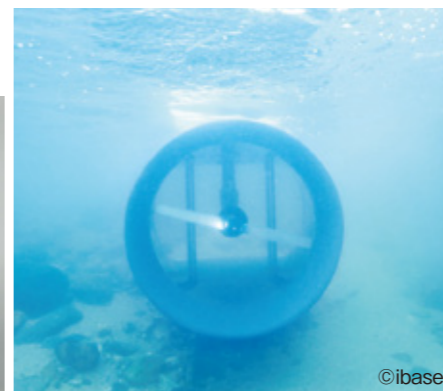
水中のCappaの様子。集水増速装置で増速した水流がプロペラを回転させて発電する。このため落差がない水路でも発電可能だ
