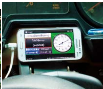
上/バスの位置情報を発信する車載器には、市販のスマートフォンを使用 左/交通情報の取得のため、市内25カ所にWi-Fiパケットセンサーを設置した
