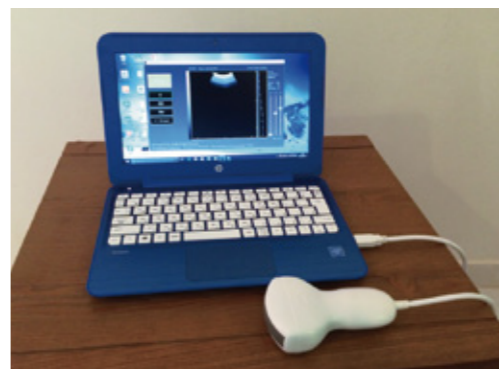
河村社長が開発した途上国向けの超音波プローブ、US-304。画像はノートパソコンや携帯型タブレットにUSBケーブルで出力する。機能をそぎ落とし、丈夫さ、軽さ、消費電力の低さなどを追求した。価格は従来製品のおよそ10分の1
