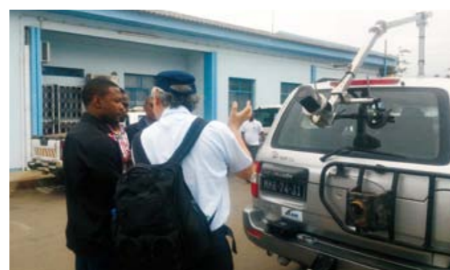
モザンビーク道路公社(カウンターパート)のスタッフの前に、岩根モバイルマッピングシステム(IMS)について説明を行う。自動車のルーフに取り付けたアームの先にカメラがある
