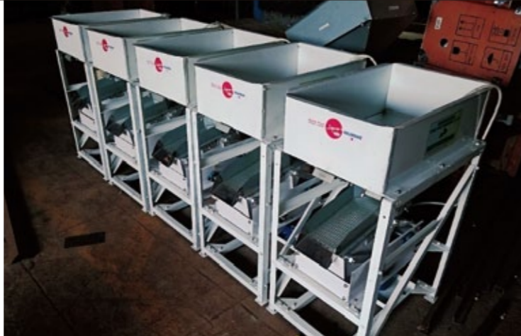
現地の農機具メーカーで試作した石抜き機。心臓部は細川製作所が現地に持ち込み、フレームなどを専用設計。現地のメーカーにて製作した。これにより高性能でありながら低コストの石抜き機が量産可能かを検証する。
