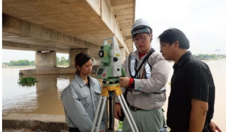
KUMONOSは遠隔地から橋梁の劣化・損傷状況を計測し、取得したデータを3次元座標で正確に記録できる。計測にかかるコストと時間を削減し、調査可能範囲を拡大できる点がメリットだ。
