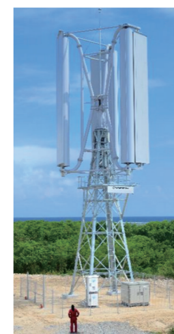
10kW垂直軸型マグナス式風力発電機
