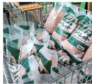
立ち枯れ木で製造したペレット試作品
