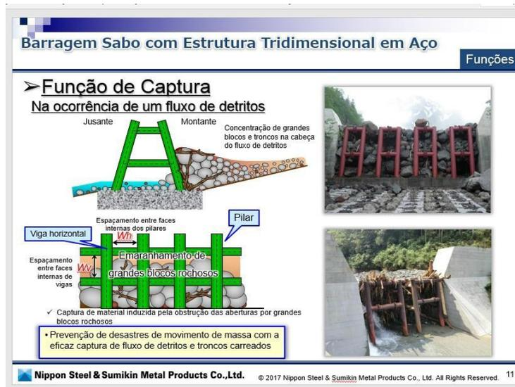
鋼製スリットダムの作動原理
