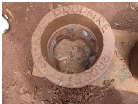
Foyer amélioré (Kamado) vulgarisé par le PRODAIRE dont la technique de fabrication est simple et réalisable seulement avec des matériaux disponibles localement.
