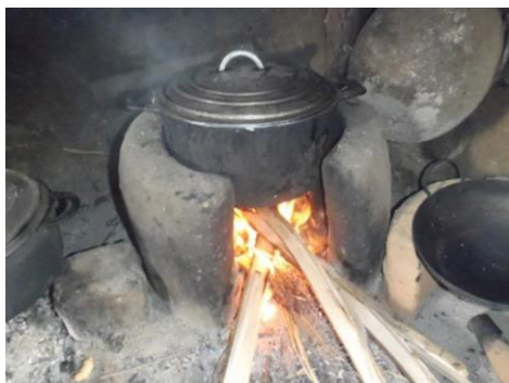
Foyer amélioré (Kamado) vulgarisé par le PRODAIRE dont la technique de fabrication est simple et réalisable seulement avec des matériaux disponibles localement.
