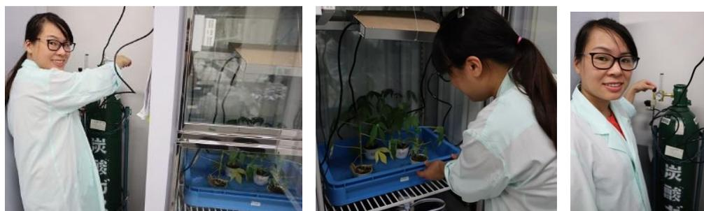
二酸化炭素濃度を高めるためインキュベーターに二酸化炭素を導入するシステムを構築、インキュベーターでキャッサバ栽培を開始、二酸化炭素濃度が規定の濃度に達したかどうか確認中
