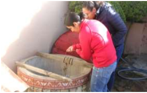
写真 3：タンクモデルのキャリブレーションデータとして使用するための不圧地下水位連続観測
